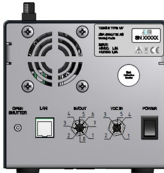
Abbildung 9: Anschlussbelegung TIDAS E
