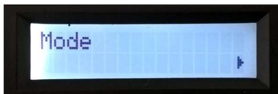
Nel menu **Mode** l'utente trova alcune routine di misurazione automatiche e una funzione che consente di controllare il funzionamento della pompa: *Radon Air Sniffing*, *Radon Soil Sniffing*, *Radon/Thoron 30 Minutes Routine*, *Radon/Thoron Fast Routine*, *Radon in Water* (necessita il Water-kit Mi.am), *Thoron Histogram* (in fase di sviluppo) e i comandi *Pump Test*. Premere il pulsante destro per accedere al menu per la selezione della routine.
