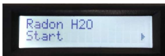
Dopo aver avviato la routine, la misura viene gestita automaticamente dallo strumento (così come il funzionamento della pompa) e sul display vengono visualizzati i dettagli della misura in corso. L'utente può premere il pulsante sinistro per interrompere la misura. Alla fine della misura appare sullo schermo il risultato (Radon in acqua in Bq/l) e nella memoria dello strumento viene salvato anche un report della routine eseguita con i dettagli della misura (parametri + conteggi).
