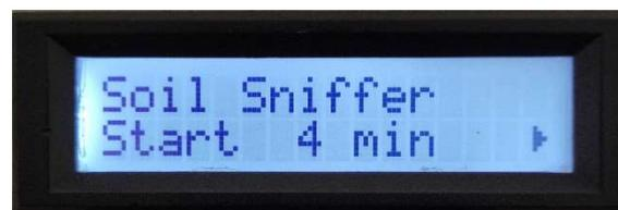
Premere il tasto destro per accedere alla selezione della durata della routine di **Soil Sniffer**: spostandosi con il pulsante inferiore l'utente può selezionare diverse durate temporali per la routine (da 3 a 10 minuti). Premere il pulsante destro per avviare la misurazione con la durata desiderata.
