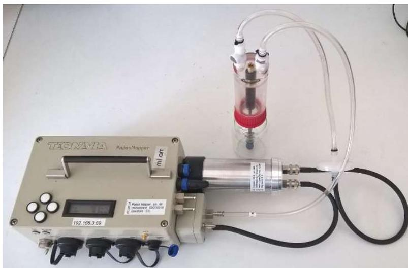
Figura 7. Esempio di circuito chiuso per routine Radon in Water.
