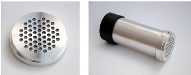
Figura 1. Testa passiva e configurazione di campionamento passivo per la cella di scintillazione.
