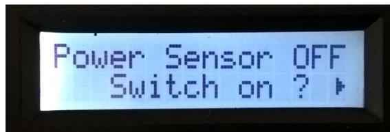
Nota: lo spegnimento del fotomoltiplicatore è obbligatorio quando l'utente deve cambiare la cella di scintillazione montata sullo strumento. Non accendere mai il fotomoltiplicatore quando non c'è una cella di scintillazione sul tappo di alloggiamento del fotomoltiplicatore.
