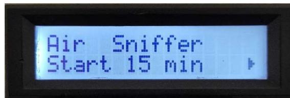
Dopo aver avviato la routine, la misura viene gestita automaticamente dallo strumento (così come il funzionamento della pompa) e sul display vengono visualizzati i dettagli della misura in corso. L'utente può premere il pulsante sinistro per interrompere la routine di misura.
