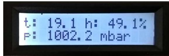
Qui l'utente può vedere i valori misurati di *temperatura esterna*, *umidità relativa* e *pressione atmosferica*. Utilizzando la freccia inferiore l'utente può visualizzare singolarmente queste grandezze più alcuni parametri aggiuntivi, come il confronto della *temperatura interna/esterna* allo strumento e la *pressione differenziale*. I parametri sono mostrati nel seguente ordine verticale:
